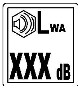
Das Etikett gibt den garantierten Geräuschpegel entsprechend der EC-Richtlinie 2000/14/EC an. Den korrekten Geräuschpegelwert finden Sie unter „Technische Daten“.
