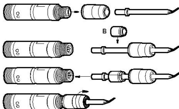
1. Faites glisser le dispositif de retenue par dessus l'emmanchement et le collet sur le burin.
